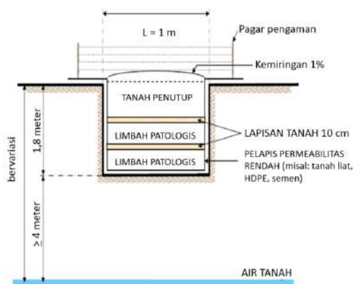
Gambar 3. Sketsa fasilitas penguburan limbah patologis dengan dimensi ukuran 1,8 m x 1m x 1m (satu koma delapan meter kali satu meter kali satu meter).
